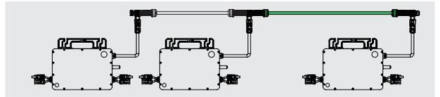
Pour débrancher le connecteur d'extension HMS de l'interconnexion CA, vous devez utiliser un outil de démontage HMS.
